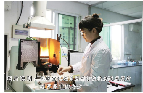
图片说明：化验室化验员用原子吸收分光光度计测定水中铁含量
